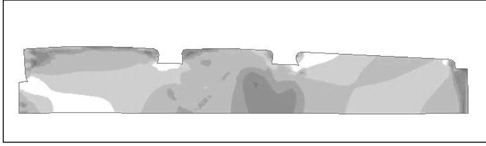
Şekil 6. Sıkıştırma sonunda bakırda von-Mises gerilme dağılımı.
