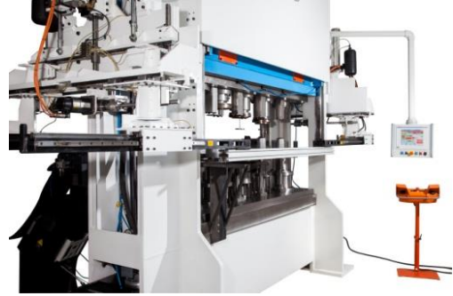
Şekil 4. Prese özel tasarlanmıř Transfer Robotu
