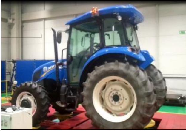
Şekil 1. Traktör 4-Poster testi.
