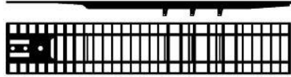
Şekil 1. Şasi sonlu elemanlar modeli
