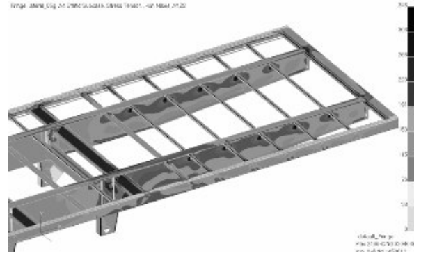
Şekil 10. Yanal yüklem, arka kısım gerilme dağılımı.
