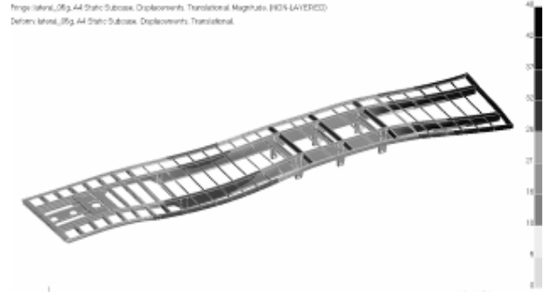
Şekil 9. Yanal yüklem, deformasyon hali.
