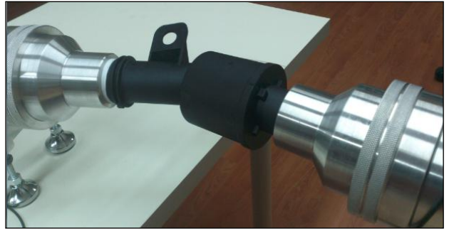
Şekil 7. Rezonatör parçasının sisteme monte edilmiş hali
