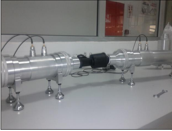
Şekil 4. Turbocharger rezonatörü için tasarlanan ses iletim kaybı ölçüm tüpü
