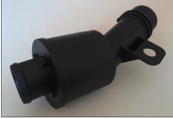
Şekil 1. Projede üzerine çalışılan plastik turbocharger rezonatörü
